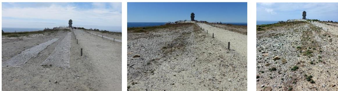
Figure 10 : Efficacité du géotextile sur la pointe de Pen Hir (à gauche : année 0 (2017), au milieu : n+3 (2020), à droite : n+5 (2022)).
